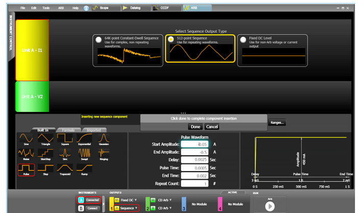
Рис. 15. ПО 14585A предлагает интерактивную среду для создания сигналов произвольной формы.
