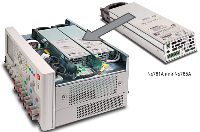
Рис. 4. N6705B с источниками питания/измерителями.
